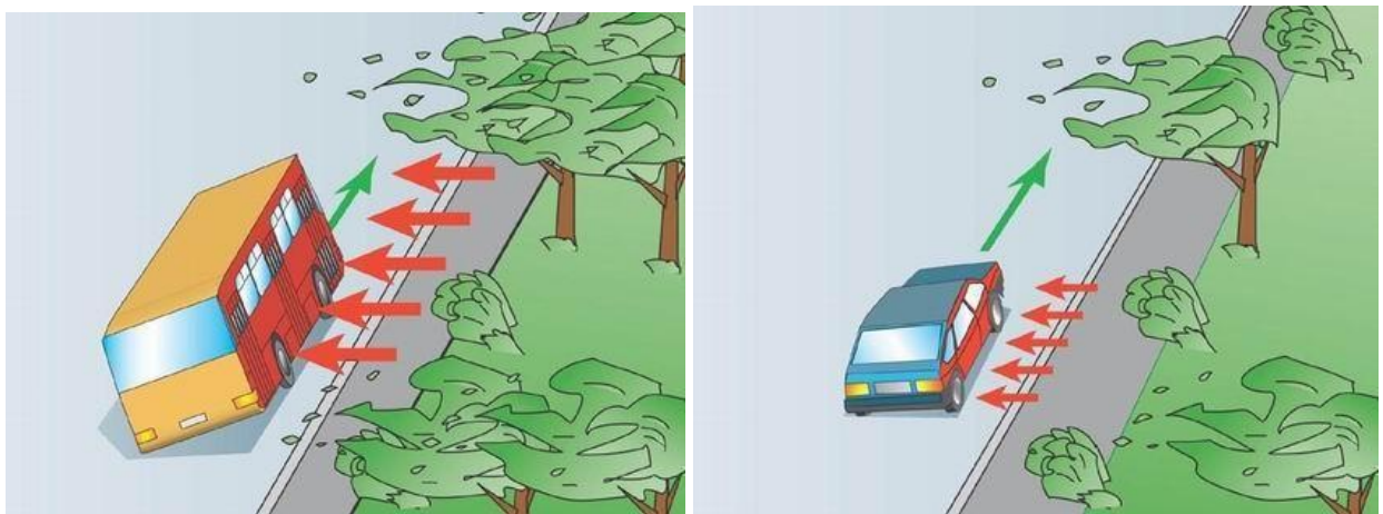
Рис. 74. Действие силы ветра на поверхность: а) большой площади; б) малой площади
