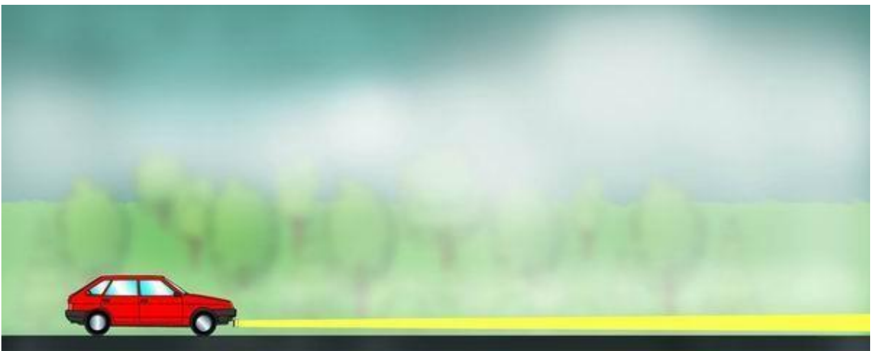
Рис. 52. Движение в тумане: а) дальний свет фар – создает белую стену; б) ближний свет фар – отодвигает эту стену; в) противотуманные фары – светят под туман
